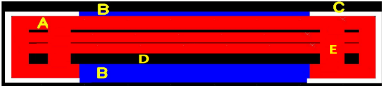
材質：絕緣樹脂 PP+銅(剖面結構圖)
